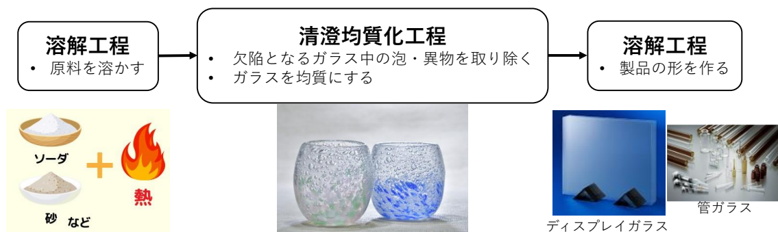
図 1.1 ガラスの連続生産工程概要図
