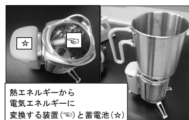
図3 バイオマス発電のモデル実験装置
