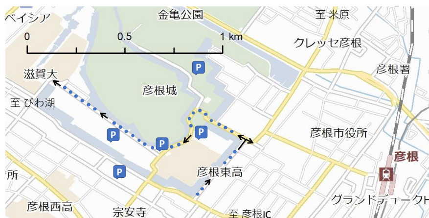
図 1 車道の一方通行化例
